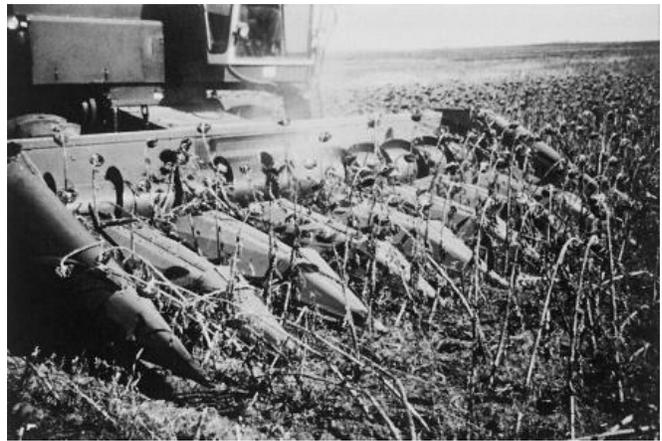
Figura Gi27.- Aspecto del cabezal de la trilladora para la cosecha de girasol
